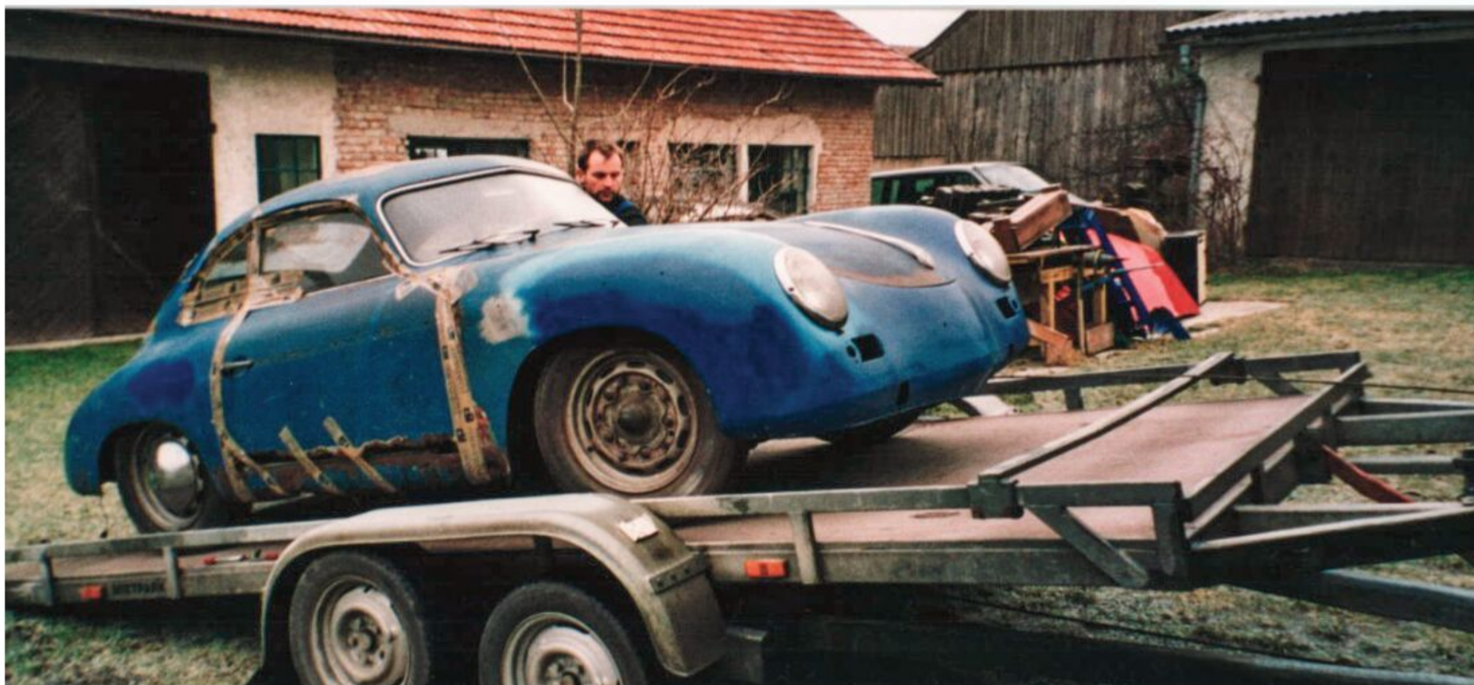
Das Auto kam aus erster 1. Hand und befand sich im unverbastelten Zustand, aber das Blech war marode und selbst Anbauteile wie der Aschenbecher (u.r.) durchgerostet.
